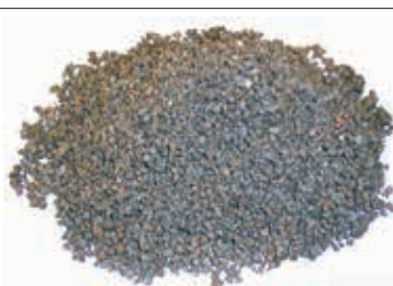
Filtralite® P 0,5-4 mm knust Leca tilsatt Dolomitt som gir meget god fosforbinding.
